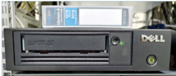
▲備份資料設備(LTO-8磁帶機及磁帶)
